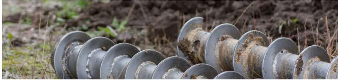
**Wärmepumpe mit Erdsonden** - Um eine Erdwärmesonde anzulegen, erfolgt zunächst eine senkrechte Bohrung. In das fertige Bohrloch wird dann ein Bündel aus Kunststoffrohren (Sonden) eingebracht, durch die man üblicherweise mit Frostschutzmittel angereichertes Wasser pumpt. Die Trägerflüssigkeit entzieht dem Boden Wärme, die über eine Sammelleitung an die Wärmepumpe des Hauses übertragen wird.
